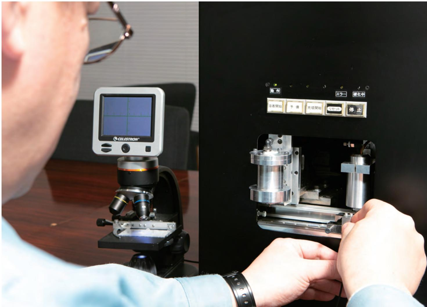
線量計のプローブの先端に機械で自動的にシンチレータ剤を充填
