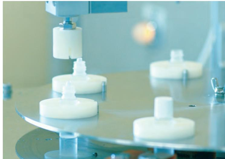
充填キャッピング設備【WB-1FCjr】 充填作業の効率と幅を広げ、キャッピングのトルク一定化により品質向上を実現
