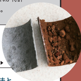
新旧の配管内部。新検査方式は寿命診断まで可能だ▶
