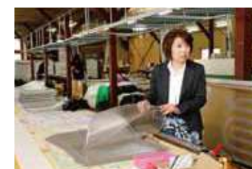
従来品のマットセンサーはシルク印刷の手法を用いて開発。
