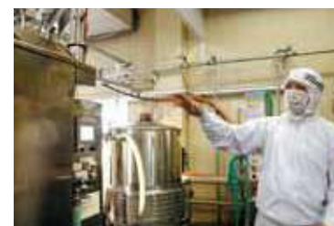
「炊く」から「蜜漬け」までの工程を処理する蜜漬け機。
