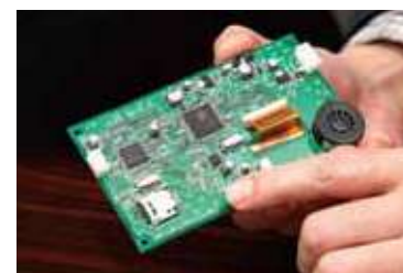
プログラムを変更して汎用性の高いものにした液晶(パネル)基盤。
