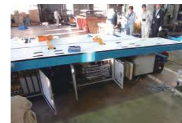
自走式の「核」となる動力部にはバッテリーを採用。パレット状の本体と電源機能をワンユニットで確立。
