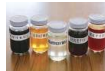
精製の各段階によって違いが出る軽油、グリセリン。こらの元になるのは家庭などで使い終わった廃食油。
