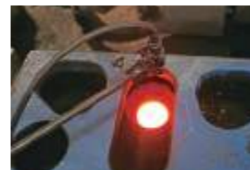
温度が10度違っても完成品には影響が出る、赤外線温度計の導入で温度管理は万全の体制に。
