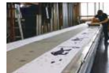
最初から終わりまで同じ力加減での移動が重要。しっかりと型に合わせて1点ずつ丁寧に染め上げる。
