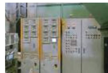
自動的に塗装対象物を判断して静電気の電流を制御、最適な帯電を可能にするガンコントローラーを導入。
