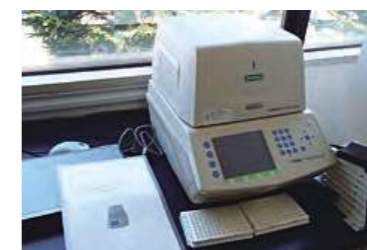
遺伝子解析を短時間で正確に行うrealtime-PCR、細胞機能の評価のためには欠くことができない装置。
