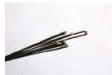
長時間高温に晒されていると外部の保護管が損傷、熱電対の保護管内部に挿入されている素線。
