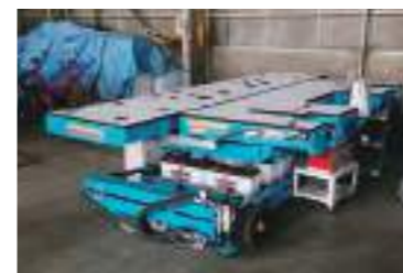
既設の手術台へ「連れて行く」スタイルではなく、「迎えに行く」設定の採用で牛のストレスを軽減。
