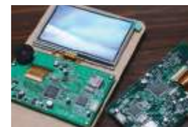
操作メニューが多数ある時はボタン指示が追いつかず、タッチパネルを組み込んだ仕様には大きな優位性がある。
