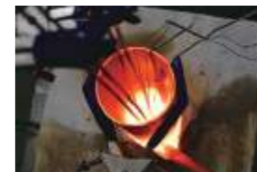
長寿命で高信頼性の熱電対保護管作製のために、熱電対素線の高温腐食環境での耐久性実証装置。
