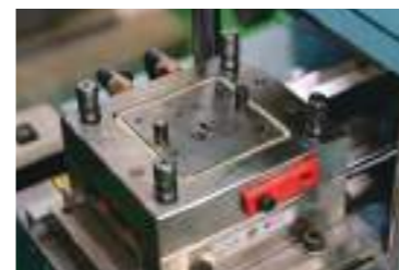
完成までは0.1mm以下との格闘を続ける、直径0.5mmの光ファイバーキャップ用金型。
