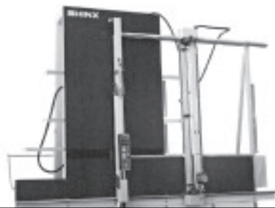
新規に導入したパネルソーは3,000ミリまで切断できる
