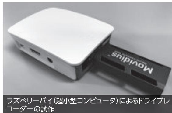
ラズベリーパイ(超小型コンピュータ)によるドライブレコーダーの試作
