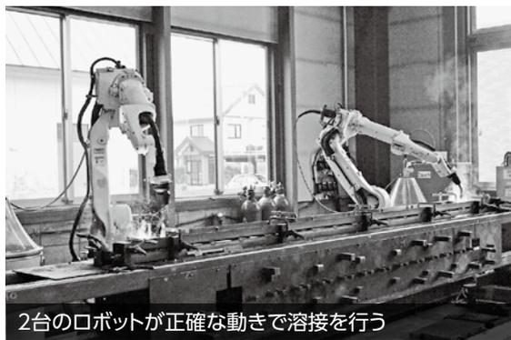
2台のロボットが正確な動きで溶接を行う
