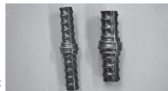
熱した鉄筋同士に圧接器で圧力を加えます
