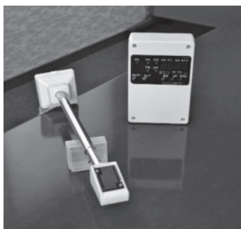
左:降雪センサー、右:制御装置(右の制御装置が今回の補助金で試作開発されたもの)
