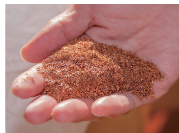
車両内部の電装部品を接続するのに用いられているワイヤーハーネスの線材である銅を、高品質・高純度でリサイクルできる
