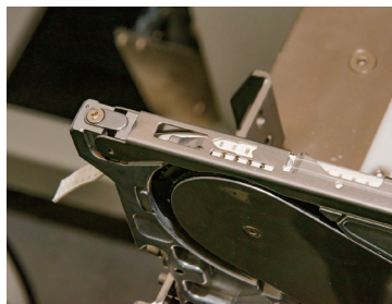
RS-1Rのフィーダはモータ駆動で、スムーズな部品送りと高速で安定した部品供給を実現。吸着位置自動補正機能をはじめ、操作性を追求し、高い生産効率を実現している。
