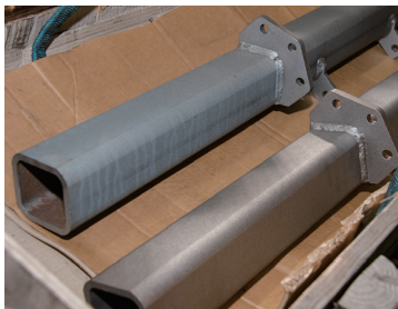
加工前の鋼材と、ショットブラストにより表面の錆や汚れを除去した鋼材(写真下)。金属表面が見違えるほどきれいになった
