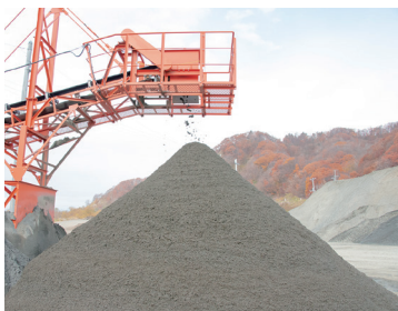
分級機で生産された砂。泥土分の多い原料でも良品質の微砂に生まれ変わる
