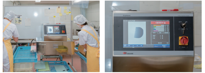
「見える安心」で製品の品質管理向上のため導入されたX線異物検査機。人間の目視での確認だと気の遠くなる作業も、機械によってスピーディーにチェック・選別できる
