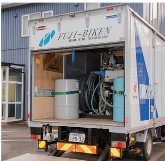
システム本体（ポンプ+ヒーター）、ホース、発電機などをすべて車両に搭載した「オール・イン・ワン」タイプの専用システムを導入。施工現場内の移動を容易とし、さらに吹付箇所の間近まで接近させられるため、作業効率が飛躍的に向上する
