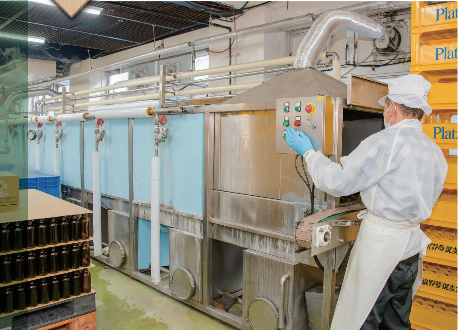
瓶詰後の製品をコンベアにて自動的に搬送し、瓶に温水シャワーをかけるトンネル型の低温殺菌装置パストライザー。ビールは充填時は5℃程度だが、それを60～70℃程度まで上げて殺菌。高温のままだと品質劣化するので、常温まで冷却する
