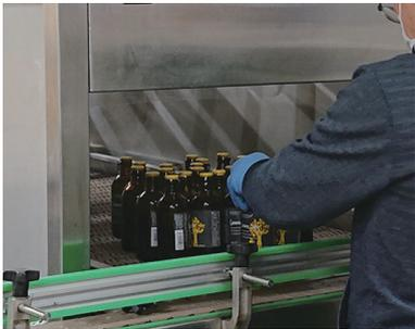
パストライザーの温水シャワーによる殺菌と冷却。果実原料をふんだんに使用したフルーツビールにおいては、液体自体の糖分が高く、果実に由来する野生酵母が残存している可能性もあるため、精度の高い殺菌作業が求められる
