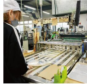
製袋作業の自動化により、キャリアが浅くても10年選手のベテランと同レベルの作業を可能にし、属人化の問題も解決するさまざまなシステム・機能を搭載している。
