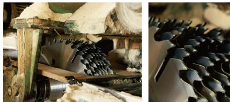
製材機に装着したチップソー。再研磨後も新品と変わらない切れ味と安定した直進性を確保し、木材を自在に切断加工していく。チップソーの買い替えコストの発生を抑えるだけでなく、刃の摩耗による切断不良を起こす前に自社で定期的に再研磨することで、安定した品質を保ちながら総合的なコストダウンを図ることに成功した。
