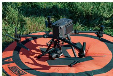
同社が導入したDJIの産業用フラッグシップ・ドローン「MATRICE 300 RTK」。レーザー測量機器を搭載しており、森林域など植生帯でも地表面の位置情報を取得することができるほか、〈相対測位〉と呼ばれる測定方法で、高精度な3次元地形情報を取得できる。さまざまな現場で必要とされる安全かつ効率的な測量業務を行うのに最適なドローンだ。
