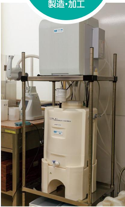
骨材の試験には水蒸気を冷却して液体に戻した純度の高い水=純水が用いられる。最新の純水装置も本事業により導入された。
