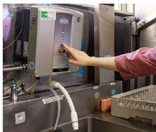
電解水生成装置は、水と塩から酸性の次亜塩素水とアルカリ性の洗浄水を作れる。化学薬品を使わないため人体や食材、環境への害がない。消毒薬による殺菌では、菌に耐性ができて薬効がなくなったり、手が荒れたりするが、この水は菌の生存環境そのものを破壊するため、効果が持続する。調理スタッフの手洗いやまな板などの調理器具の消毒、キッチンの清掃などに活用されている。
