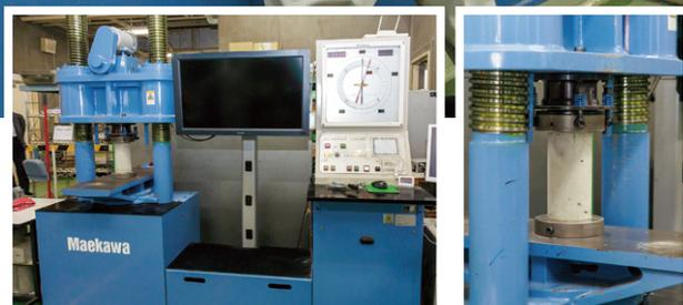
本事業を活用し、新たに12種の試験用機材が導入され、生コン原材料試験や各種コンクリート試験などを効率的に実施できる環境が整備された。写真は、コンクリートの圧縮強度を推定する検査の様子。構造物の耐力上重要であるばかりでなく、耐久性を評価する上でも重要な要素であり、精度の高い検査が求められる。打ち上がった構造物から切り取ったコア供試体をその垂直方向に圧縮応力を加えて試験する。
