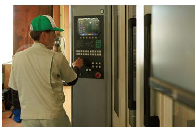
チップソーをセッティングした後、オペレーターがタッチパネルで操作する。10インチ液晶カラーディスプレイと多機能操作パネルで、これまで熟練作業者が行っていた研磨作業を、初心者でも簡単なティーチングで迅速・確実に操作・実行できる。松永社長は「熟練作業者の経験や勘もデジタルに落とし込み自動化してくれる。最良の加工品質と最高の生産性を達成できた」と話す。
