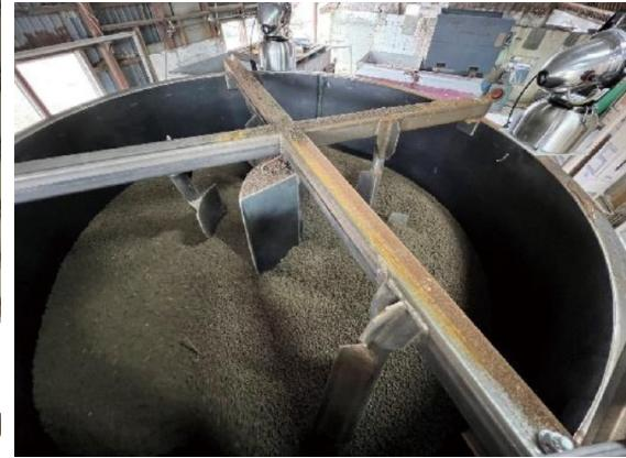
本事業で導入した自動計量機付き攪拌機、微粒子噴霧器を使った有用微生物入り有機肥料の製造の様子。攪拌機の中で完熟発酵鶴糞に、同社独自の有用微生物「スピカ菌8」を微粒子噴霧器で噴霧し、攪拌することで微生物を満遍なく均一に付着させる。
