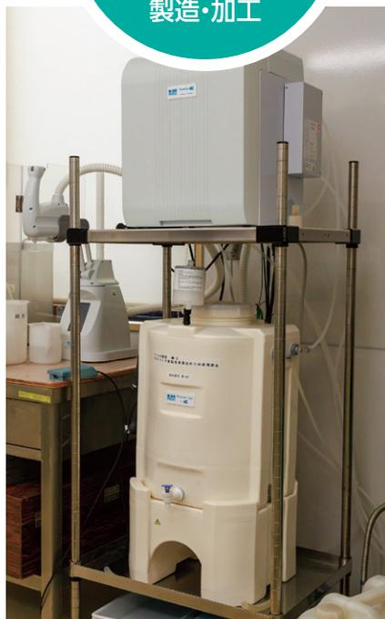
骨材の試験には水蒸気を冷却して液体に戻した純度の高い水=純水が用いられる。最新の純水装置も本事業により導入された。
