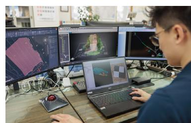
本事業では、ドローンとともにドローンで撮影した写真から自動的に点群データを図化処理し、高い精度で距離や面積、堆積を算出する「測量ソフトウェア」と、情報処理能力・画像処理能力に優れた高性能パソコンを測量ソフトウェア専用PCとして導入した。
