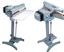
電動式攪拌機に完熟発酵鶏糞を投入する様子と袋詰め工程に導入された足踏み式シーラー。電動式攪拌機の導入により、天候によらず屋内で製造可能となり、製造工程にかかる人員は2名から1名へと省人化に成功した。また、足踏み式シーラーの導入で袋詰め工程にかかる人員も4名から1名に削減できた。
