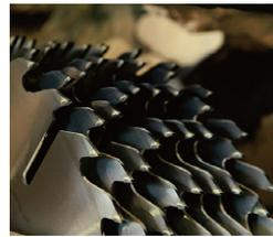
製材機に装着したチップソー。再研磨後も新品と変わらない切れ味と安定した直進性を確保し、木材を自由自在に切断加工していく。チップソーの買い替えコストの発生を抑えるだけでなく、刃の摩耗による切断不良を起こす前に自社で定期的に再研磨できることで、安定した品質を保ちながら総合的なコストダウンを図ることに成功した。
