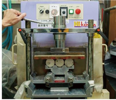
本事業を活用して刷新された供試体研磨機は、コンクリートのコア供試体の端面を3本まで同時に研磨する機材。コンクリートの壁や床に直接穴を開けて、円柱状に切り出したものがコア供試体だ。コア供試体は、圧縮強度試験など各種試験を行う前に、規定の寸法に合わせて端面などを研磨する必要がある。
