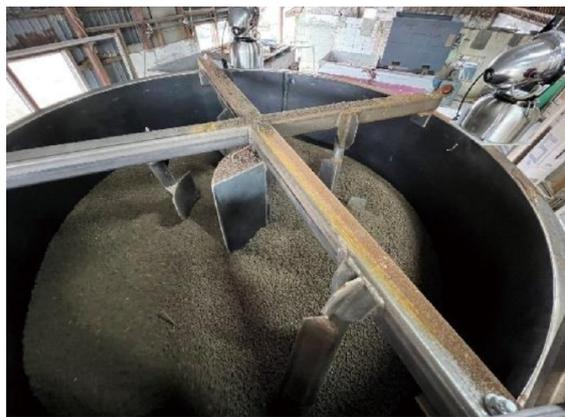
本事業で導入した自動計量機付き攪拌機、微粒子噴霧器を使った有用微生物入り有機肥料の製造の様子。攪拌機の中で完熟発酵鶏糞に、同社独自の有用微生物「スピリ菌8」を微粒子噴霧器で噴霧し、攪拌することで微生物を満遍なく均一に付着させる。
