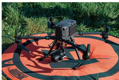
同社が導入したDJIの産業用フラッグシップ・ドローン「MATRICE 300 RTK」。レーザー測量機器を搭載しており、森林域など植生帯でも地表面の位置情報を取得することが可能であるほか、〈相対測位〉と呼ばれる測定方法で、高精度な3次元地形情報を取得できる。さまざまな現場で必要とされる安全かつ効率的な測量業務を行うのに最適なドローンだ。
