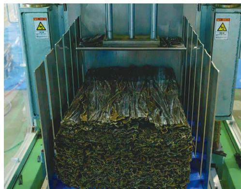
自動化により昆布の切断面にひび割れが少なくなった。作業時間が大幅に短縮すると同時に、従来の手作業に比べ、昆布の端材・端っここの余り部分（ロス）の削減にもつながっている。
