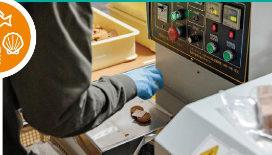
本事業で導入した菓子の自動包装機械。フィルムの上に商品を置くだけで、あとは機械が自動で包装してくれる。焼き菓子などを自動で包装することによって販売個数が増え、それまで手作業で包装していた人員や時間を販売などほかの仕事に回せるので、結果的に売り上げアップにつながった。フィルムを下から供給してコンベアにのせる方式で、フィルムの上に直接商品をおくことができ、衛生的にも安心だ。
