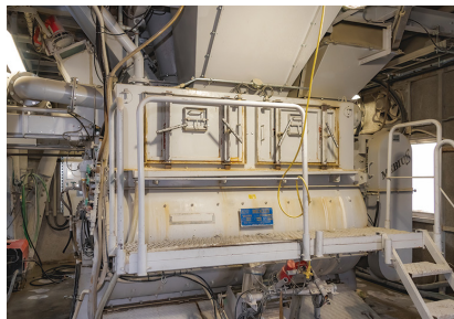
プラントの頭脳部分であるコンピュータ制御室の計量制御操作機器からの遠隔指示により、プラントの上部から計量器（写真）に運ばれ、それぞれの材料が適切に計量され、下部のミキサに入れられ、練り混ぜられる
